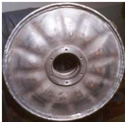
Рис. 2. Плазменная наплавка торцевых поверхностей обода катка
