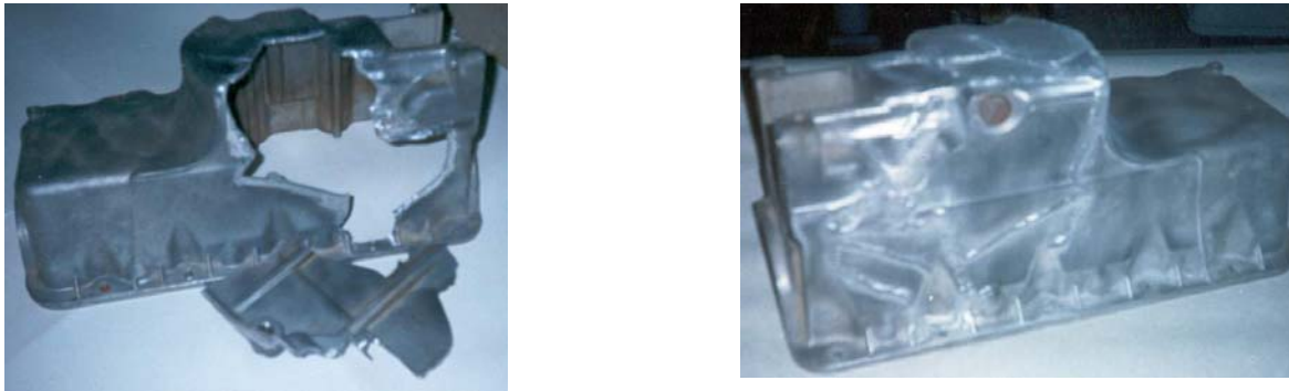
Рис. 12. Ремонтная плазменная сварка картера автомобиля.
